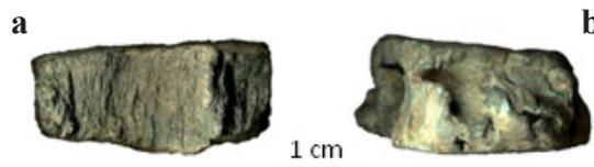
**Fig. 7** – Cassure de lingots plano-convexes de cuivre. 7a : cassure à froid ; 7b : cassure avec ramollissement dû à la chaleur (dépôt de Kergaradec, Gouesnac'h, Finistère).
