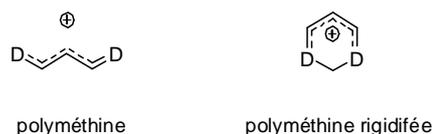
**Figure 37 : rigidification d'une polyméthine**
