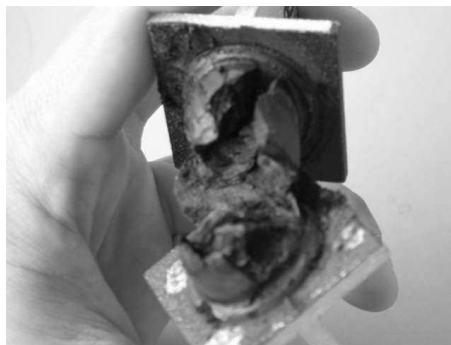
FIG. II - 3.9 – Rupture d'une éprouvette Diabolo en compression répétée.
