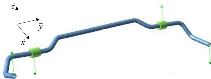
FIG. III - 3.1 – Schéma de la barre stabilisatrice équipée de ses paliers sous chargement.
